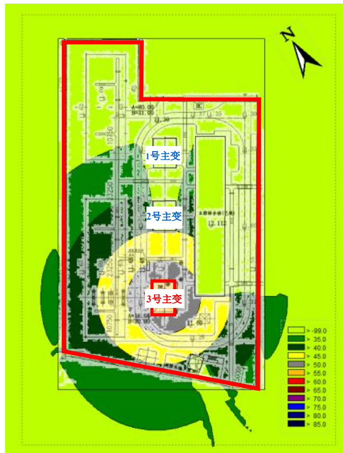
图 4-2 惠安玉围 110kV 变电站厂界噪声预测等声级线图
