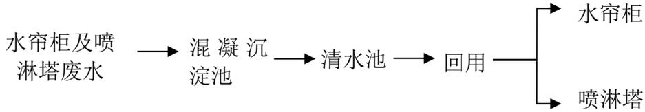
图 4.2-1 生产废水处理工艺流程
